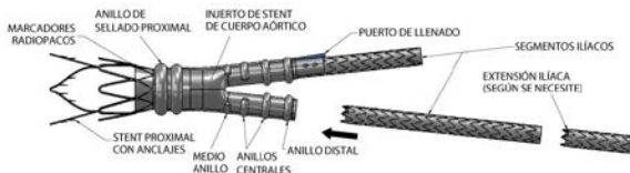
Figura 1. Esquema del sistema de injerto de stent abdominal Ovation Prime de TriVascular desplegado con la endoprótesis vascular iliaca Ovation Prime u Ovation iX
