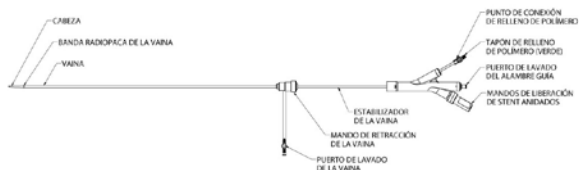
Figura 3. Esquema del catéter de colocación del sistema de injerto de stent abdominal Ovation Prime de TriVascular
