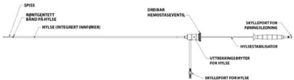
Figur 5. Illustrasjon over innføringskateter for TriVascular Ovation iX Iliacstentgraft
