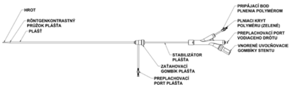
Obrázok 2. Schéma zavádzacieho katétra aortického tela systému abdominálneho stentgraftu TriVascular Ovation Prime
