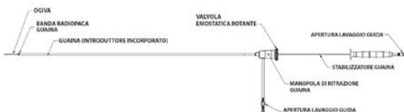
Figura 3. Schema del catetere di rilascio del corpo aortico nel sistema stent-graft addominale TriVascular Ovation iX
