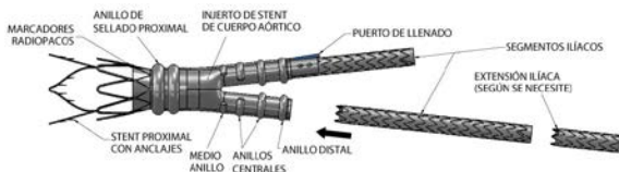
Figura 1. Esquema del sistema de injerto de stent abdominal Ovation iX de TriVascular desplegado
