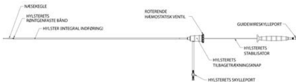
Figur 4. Oversigt over indføringskateter til TriVascular Ovation iX iliaca-gren/ indføringskateter til iliaca-forlængelse
