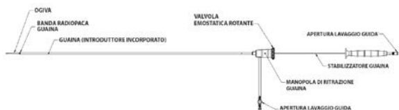
Figura 5. Schema del catetere di rilascio dell'Endoprotesi iliaca TriVascular Ovation iX
