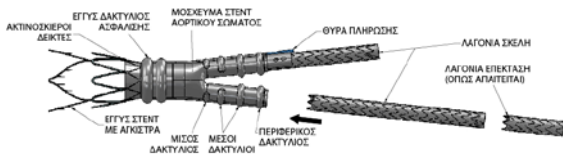
Εικόνα 1. Σχηματικό διάγραμμα εκπτυγμένου συστήματος κοιλιακού μοςχεύματος στεντ TriVascular Ovation Prime
