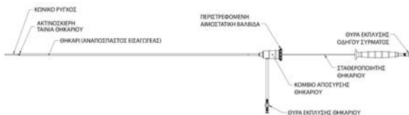
Εικόνα 5. Σχηματικό διάγραμμα καθετήρα εφαρμογής Μοσχεύματος λαγόνιας ενδοπρόθεσης TriVascular Ovation iX
