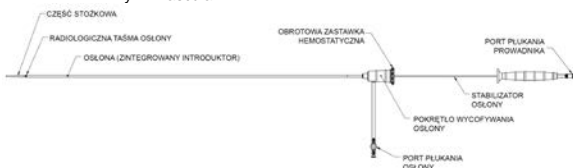
Rysunek 5. Schemat cewnika wprowadzającego stent-graftu biodrowego Ovation iX firmy TriVascular
