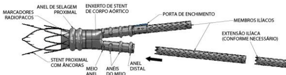
Figura 1. Esquema do Sistema de enxerto de stent abdominal Ovation iX desdobrado
