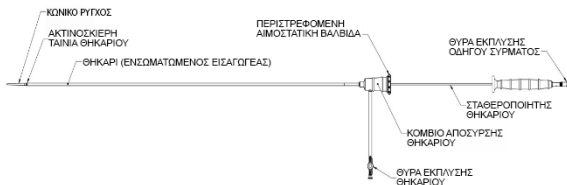
Εικόνα 4. Σχηματικό διάγραμμα καθετήρα εφαρμογής μοσχεύματος λαγονίου σκέλους/λαγόνιας επέκτασης Ovation iX
